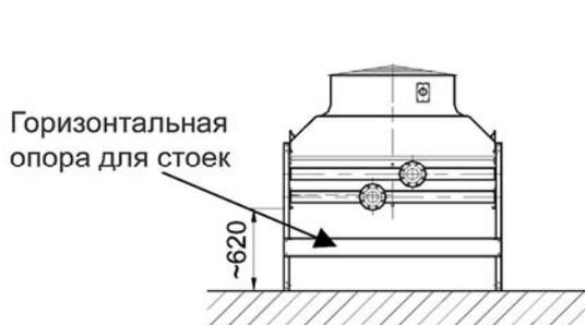
Рис. 3.5 Установка прямо на стойки
